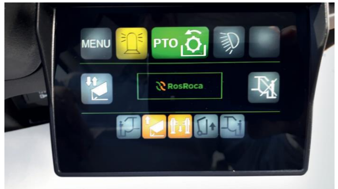
CAN-BUS-systeem en display in de cabine.
